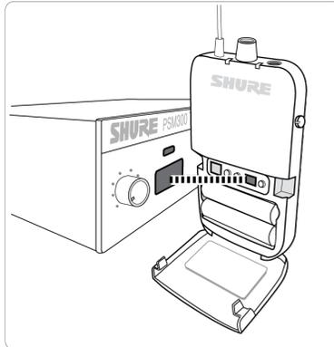
*Alinee la ventana IR del receptor con la del transmisor para sincronizarlos.*
