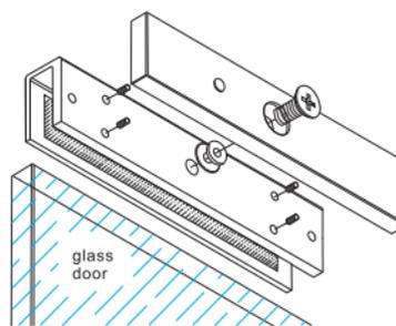
Instalación de montaje en U
