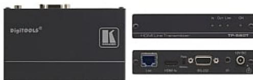
El TP-580T es un transmisor HDBaseT para señales HDMI 4K@60 (4:2:0), RS-232 bidireccional e IR. Extiende sobre cable de par trenzado CAT, 40 metros una señal HDMI con resolución de hasta 4K@60Hz (4:2:0) 24bpp. El sistema puede alcanzar distancias superiores con resoluciones HD, inferiores a la especificada
