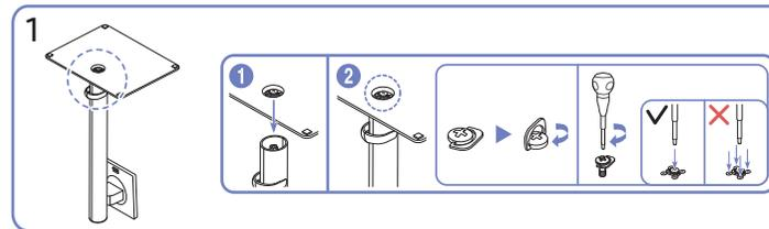
Coloque la base del soporte sobre el cuello del soporte, de acuerdo con la dirección que se muestra en la figura. Compruebe que el conector del soporte esté bien asegurado. Gire completamente el tornillo de conexión en la parte inferior del soporte para que quede firmemente sujeto. Ajuste el tornillo grande del centro para el montaje.
