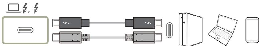
Según la especificación de suministro de alimentación por USB 3.0, puede cargar su PC si la conecta a nuestro producto mediante un cable Thunderbolt™ 3 / 4 o un cable USB Tipo C.
