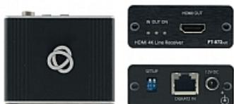
PT – 872xr es un receptor de par trenzado DGKat™ 2.0 de alto rendimiento y largo alcance para señales HDR HDMI 2.0 y HDCP 2.2 4K @ 60Hz (4: 4: 4) con alimentación bidireccional. Convierte la señal DGKat™ 2.0 transmitida en una señal HDMI. PT – 872xr, extiende la señal hasta 50m (160ft) a 4K @ 60Hz (4: 4: 4) y hasta 70m (230ft) a 4K @ 30Hz (4: 4: 4) 24bpp cuando se emplean los cables blindados de Kramer
