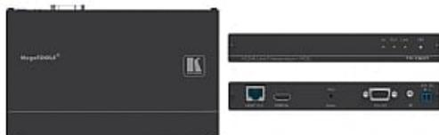
El TP-780T es un transmisor HDBaseT para señal 4K@60Hz (4:2:0) HDMI, RS-232 e IR sobre par trenzado. El TP-780T convierte las señales de entrada en una señal HDBaseT para su transmisión. Extiende la señal de video hasta 40m sobre cables CAT de cobre y una resolución máxima de 4K@60Hz (4:2:0). Distancias superiores se pueden alcanzar con resoluciones de video HD
