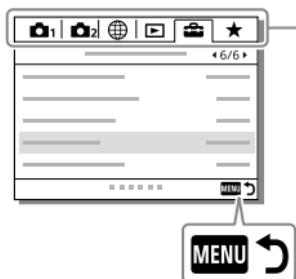
Seleccione un ícono en la parte superior de la pantalla y pulse el lado izquierdo/derecho de la rueda de control para moverse a otro elemento de MENU.
