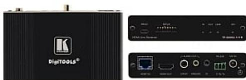
TP - 580RA es un receptor HDBaseT para señales de HDMI 4K a 60 Hz (4: 2: 0), RS-232, IR y audio estéreo de alto rendimiento y largo alcance sobre par trenzado, que desemebea la señal de audio estéreo en un puerto analógico y digital. Extiende las señales de video hasta 40 m (130 pies) sobre cables de cobre CAT hasta una resolución de video de 4K @ 60Hz (4: 2: 0) 24bpp y proporciona un alcance aún mayor para resoluciones de video HD más bajas
