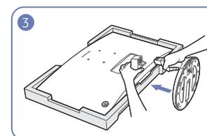
Coloque en el suelo el acolchado protector de poliestireno extrusionado (Styrofoam) incluido en el paquete y, a continuación, coloque el producto boca abajo sobre el protector, como se muestra en la imagen.
