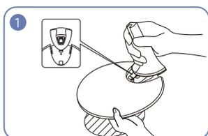
Inserte el conector del soporte en éste en la dirección que se muestra en la ilustración.
