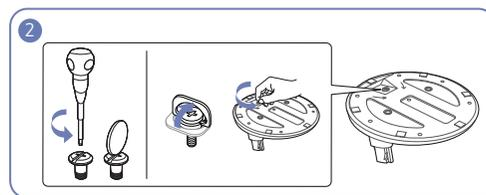
Gire el tornillo de conexión en la parte inferior del soporte para quitarlo.
