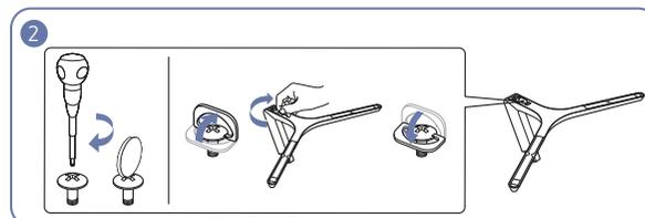
Gire completamente el tornillo de conexión en la parte inferior del soporte para que quede firmemente sujeto.
