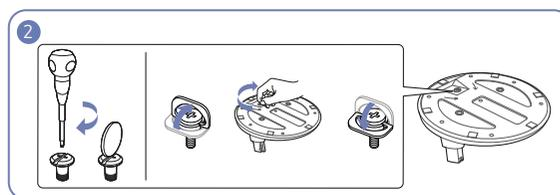
Gire completamente el tornillo de conexión en la parte inferior del soporte para que quede firmemente sujeto.
