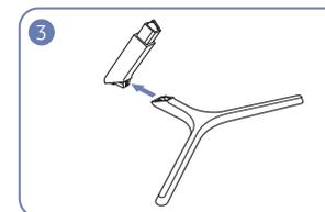
Extraiga el conector del soporte del soporte tirando de él en la dirección de la flecha, como se muestra en la ilustración.
