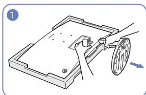
Coloque en el suelo el acolchado protector de poliestireno extrusionado (Styrofoam) incluido en el paquete y, a continuación, coloque el producto boca abajo sobre el protector, como se muestra en la imagen.
