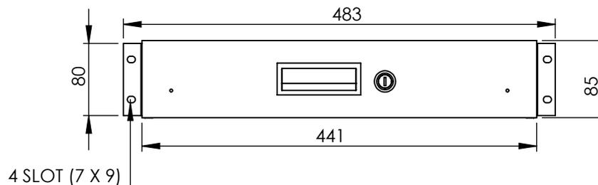
1. Fabricado en lámina de acero rolado en frío calibre 16, 18 y 22.
