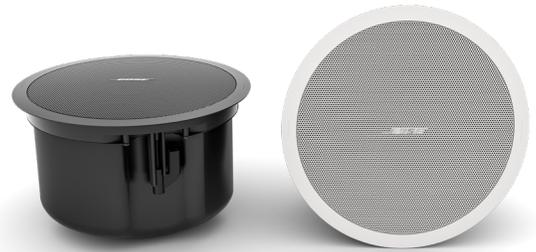
El FS4CE es un modelo para montaje en techo con un transductor de rango completo de 114 mm (4.5"), rango de baja frecuencia de hasta 70 Hz y una sensibilidad de 88 dB SPL/1W a 1m.
