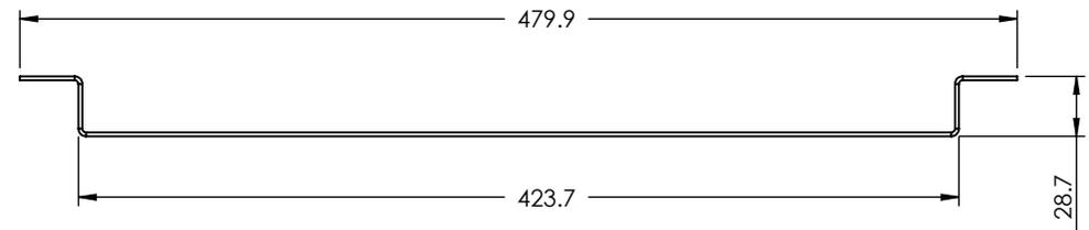
1. Fabricado en lámina de acero calibre 14 color negro.
