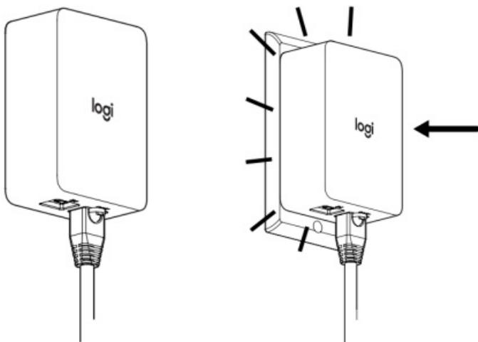
**STEP 6: CONNECT SECOND CAT5E CABLE TO THE POWER INJECTOR**
