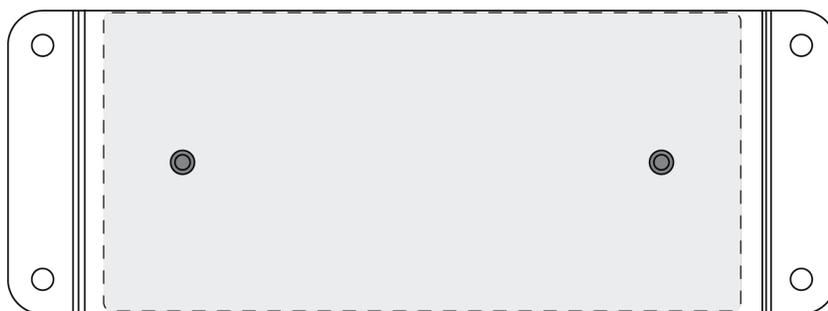
*Alinee los agujeros como se muestra para asegurar un solo dispositivo en la bandeja de montaje de una unidad*
