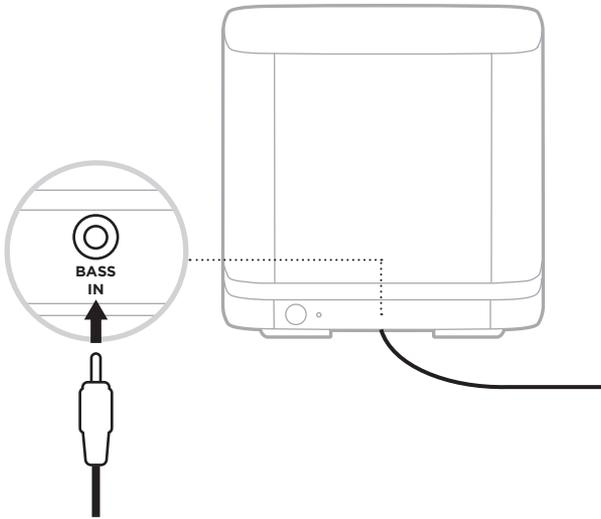
2. Conecte el otro extremo del cable al conector **BASS** en la parte posterior de la barra de sonido.
