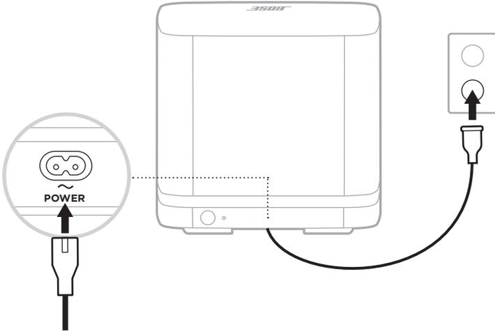
2. Enchufe el otro extremo del cable de corriente a una salida de CA (red eléctrica).
