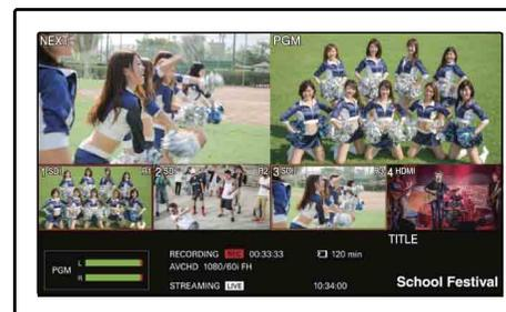
Los vídeos asignados a las entradas, el vídeo de salida de programa (PGM), el estado de la unidad y demás información se muestran en un monitor externo. También se pueden realizar preparaciones, como ajustes de audio y compuestos de Key, mientras se utiliza el visor múltiple.
