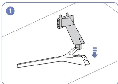
Inserte el conector del soporte en éste en la dirección que se muestra en la ilustración.
