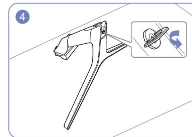
Extraiga el conector del soporte tirando de él en la dirección de la flecha, como se muestra en la ilustración.
