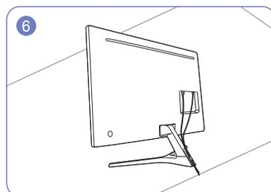
Conecte la fuente de alimentación y el cable de datos como se indica en la ilustración.
