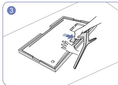
Presione la parte inferior del monitor con una mano y, con la otra, tire del soporte en la dirección de la flecha, tal y como se indica en la ilustración.
