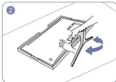
Para desmontar el soporte del monitor, presione la parte inferior del monitor con una mano y con la otra mueva el soporte hacia los lados para crear una separación.
