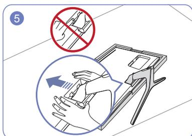
Sujete el cuerpo principal con la mano como se muestra en la ilustración. Presione el soporte montado dentro del cuerpo principal en la dirección de las flechas, como se muestra en la ilustración.
