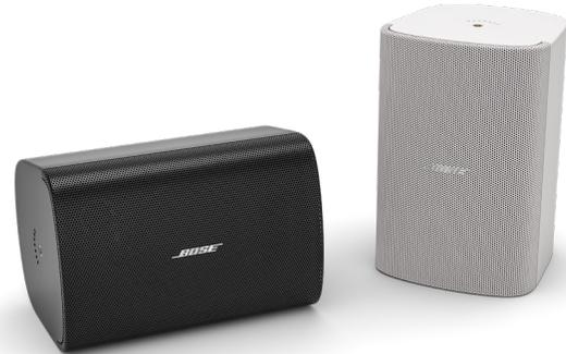
El FS4SE es un modelo para montaje en superficie con un transductor de rango completo de 114 mm (4.5"), rango de baja frecuencia de hasta 70 Hz y una sensibilidad de 89 dB SPL/1W a 1m.
