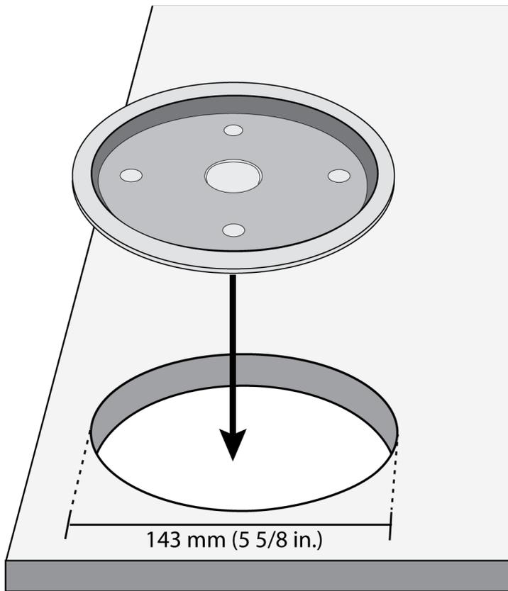
5. Deslice el cable por el agujero en el centro de la bandeja. Luego, coloque el tubo a través del agujero en la mesa y suavemente presione el micrófono en la bandeja. Alinee el logotipo de Shure en el micrófono con el logotipo de Shure en la bandeja. Los cuatro pies de goma en la parte inferior del micrófono encajan en los cuatro agujeros más pequeños de la bandeja.
