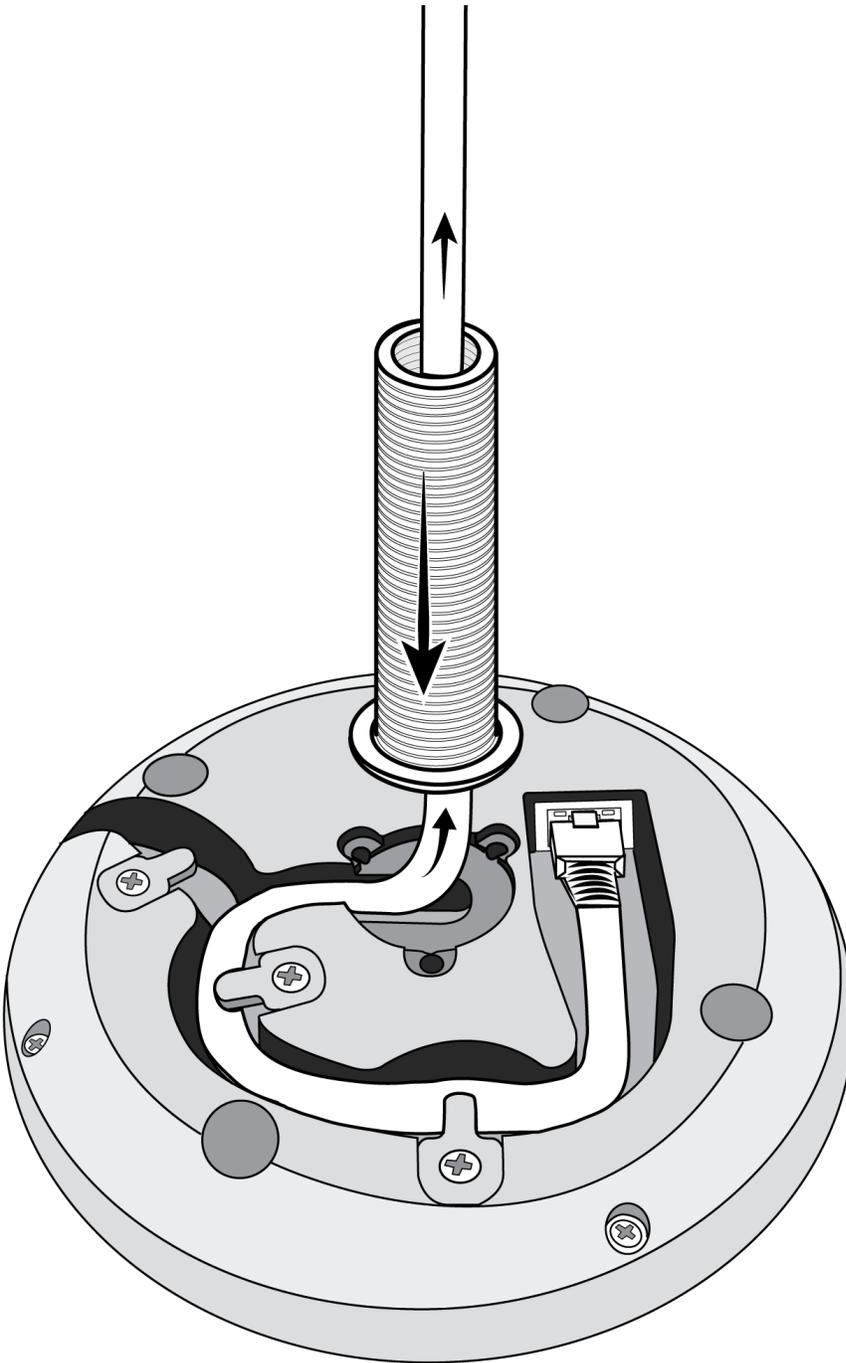
3. Alinee el tubo en el área con hendidura en el centro del micrófono. Instale los 3 tornillos (que retiró en el Paso 1) para asegurar el tubo.
