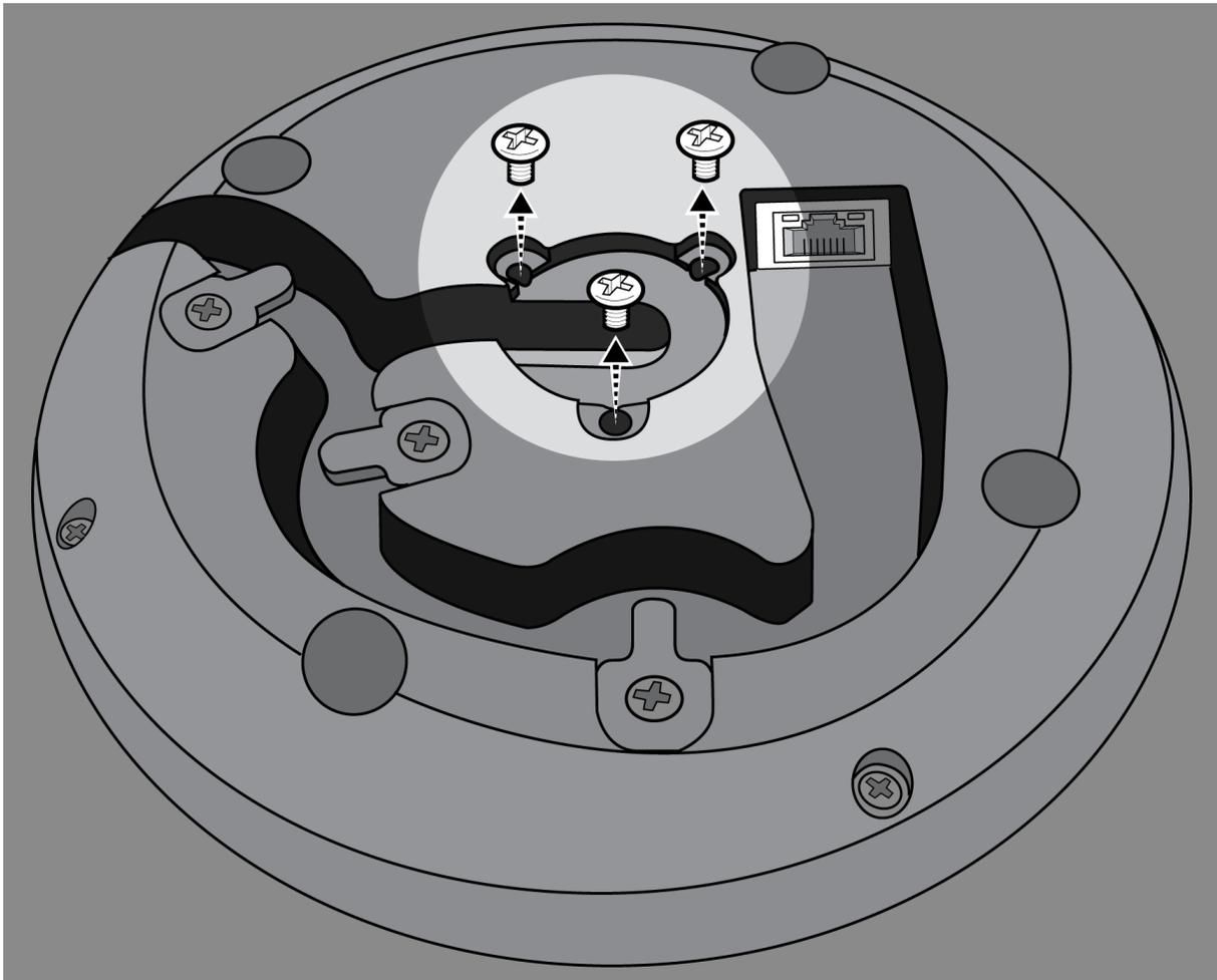
2. Conecte un cable de red al micrófono y guíelo a través del paso de salida del centro. Cuando haya asegurado el cable, guíelo a través del tubo.
