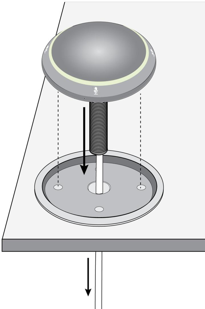
6. Coloque el soporte debajo de la mesa, con el tubo pasando por el orificio. Para mesas más gruesas ( $\geq 55$  mm), gire el soporte boca abajo para obtener una holgura adicional.
