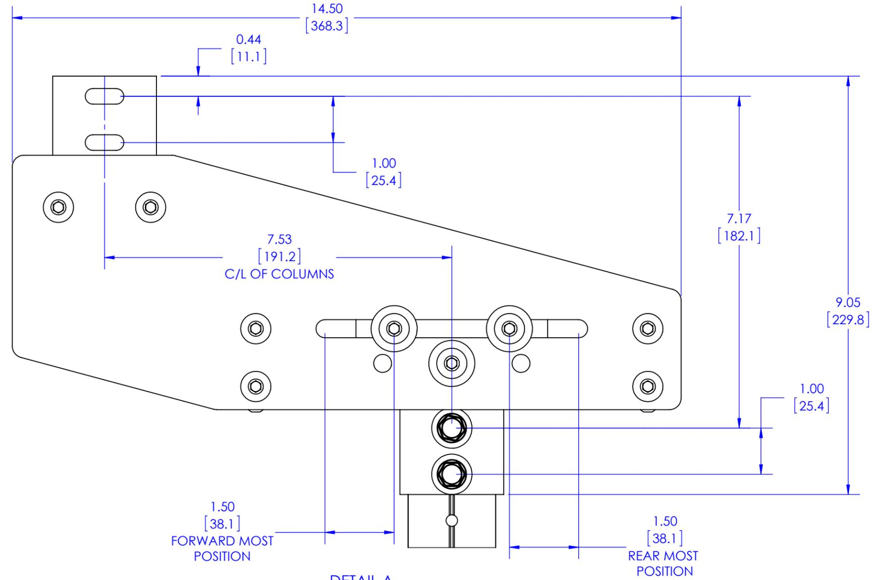
OFFSET SHOULD BE PUT IN THE FORWARD MOST POSITION FOR SCREENS LESS THAN 2.5" DEEP
