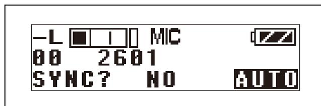
Cuando los sintonizadores 1 y 2 están activados, los ajustes del sintonizador 1 y del transmisor se configuran y, a continuación, se inicia la comunicación por infrarrojos del sintonizador 2. Del mismo modo que para el sintonizador 1, coloque el receptor de infrarrojos del transmisor que desea establecer para el sintonizador 2 cerca del puerto de transmisión de infrarrojos de esta unidad.
