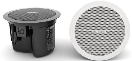
El FS2C es un modelo para montaje en techo con un transductor de rango completo de 57 mm (2.25"), rango de baja frecuencia de hasta 83 Hz y una sensibilidad de 86 dB SPL/1 W a 1 m.
