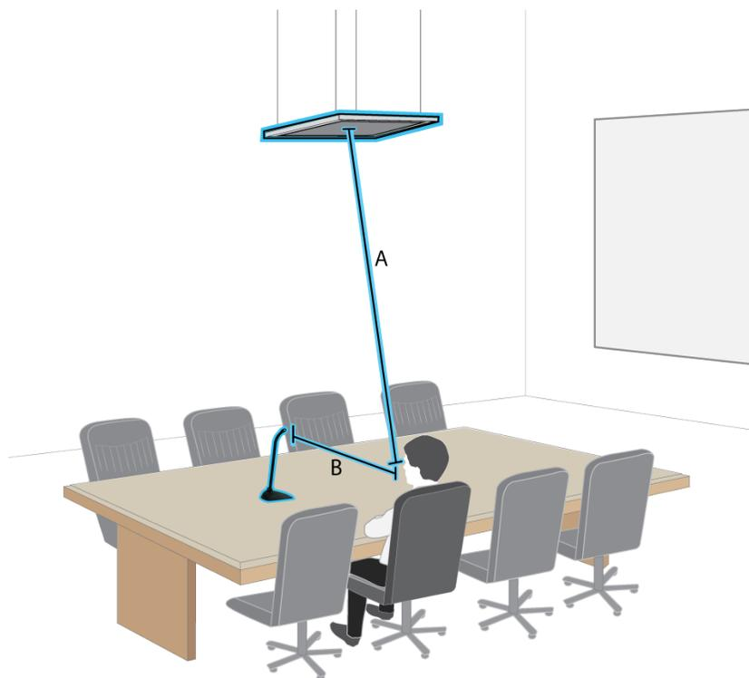
*En este ejemplo, el funcionamiento acústico del micrófono tipo array montado (A) a pies de distancia del orador coincide con el micrófono cardioide de cuello de ganso colocado a una distancia de (B) pies del orador.*
